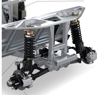
4-WHEEL HYDRAULIC DISC BRAKING SYSTEM
